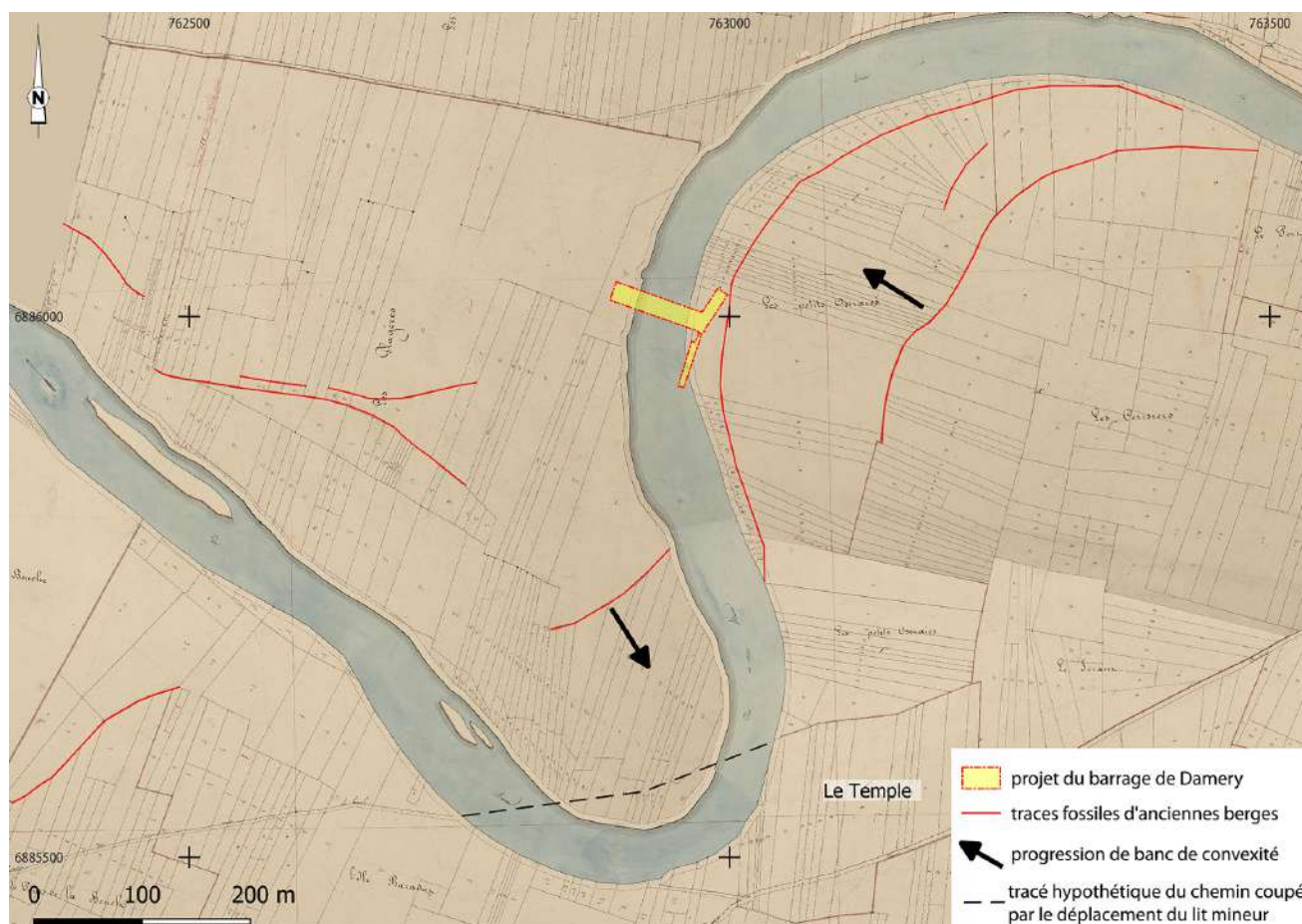
Figure 1 – Carte interprétative de la dynamique fluviale de la Marne élaborée à partir des traces fossiles observées dans le parcellaire de Damey, 1831, Arch. dép. Marne, 3P3913 (O. Bauchet © Inrap).
